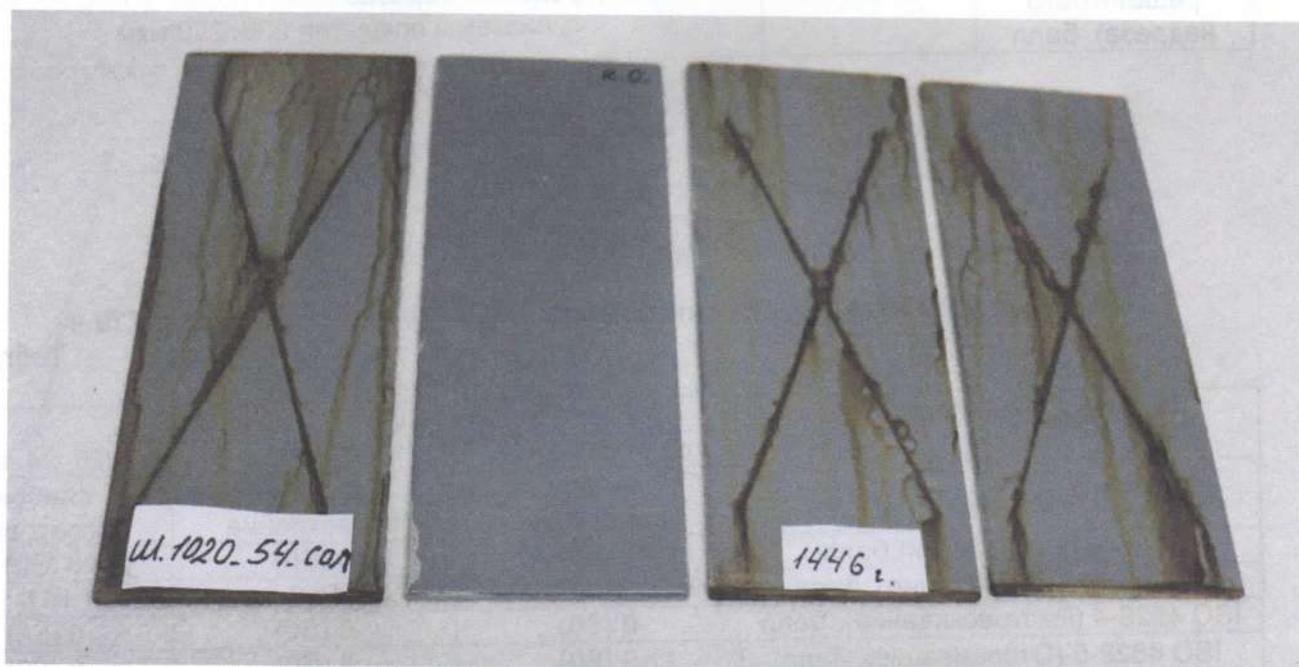
Рис. 9. Эмаль «PRIMATAN TOP 55» по стали, грунтованной грунтовкой «PRIMAPOX ST-LT», после 1440 часов соляного тумана.
