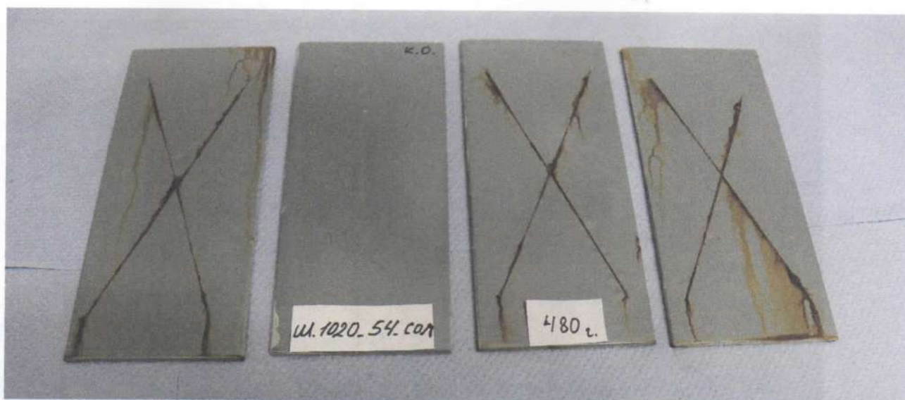
Рис. 7. Эмаль «PRIMATAN TOP 55» по стали, грунтованной грунтовкой «PRIMAPOX ST-LT», после 480 часов соляного тумана.
