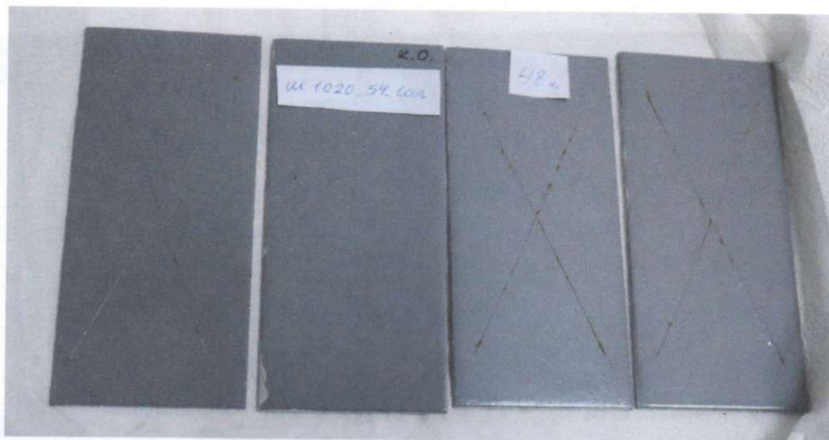
Рис. 4. Эмаль «PRIMATAN TOP 55» по стали, грунтованной грунтовкой «PRIMAPOX ST-LT», после 48 часов соляного тумана.
