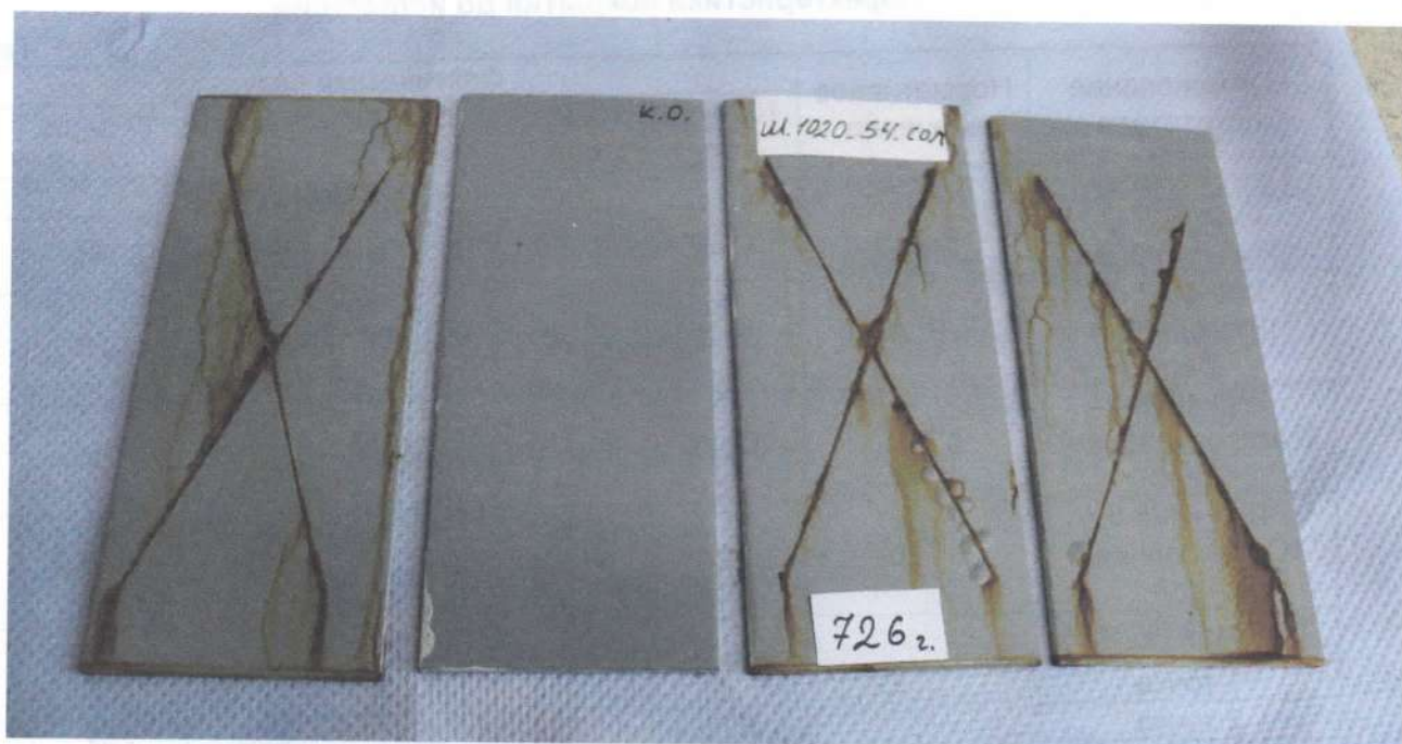
Рис. 8. Эмаль «PRIMATAN TOP 55» по стали, грунтованной грунтовкой «PRIMAPOX ST-LT», после 726 часов соляного тумана.
